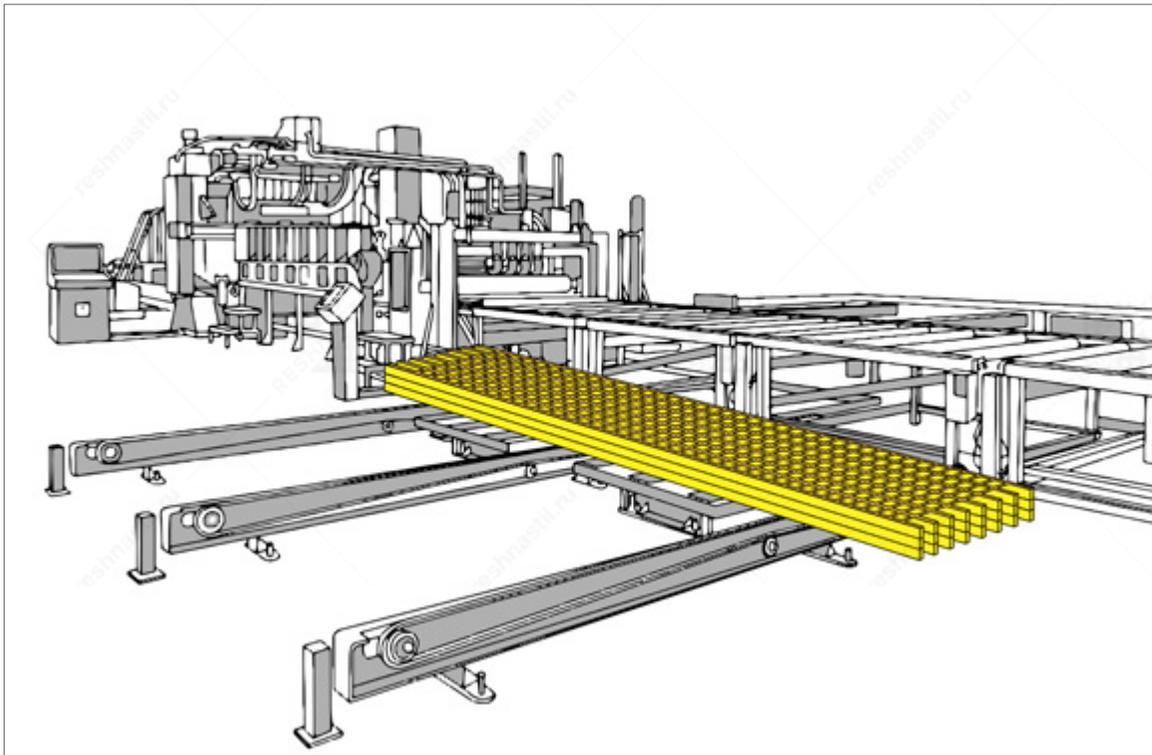
5. Изготовление матов (кассет) решетчатого настила размером 6,1x1 м
